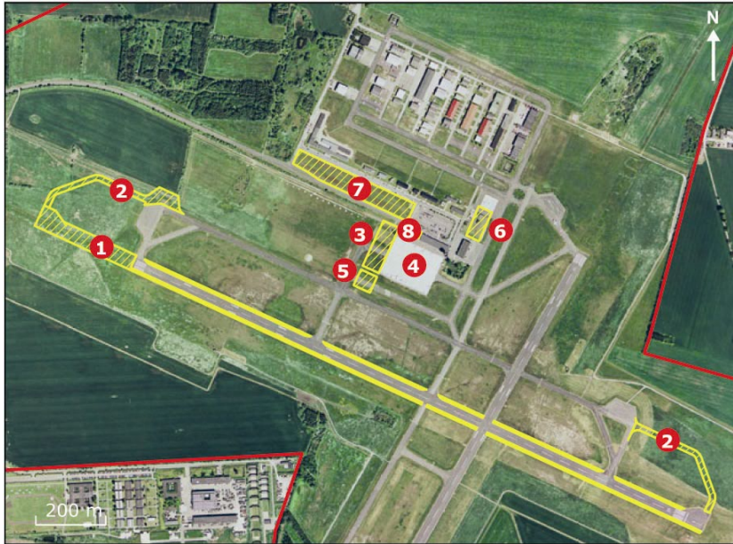
Figur 2-3: Faciliteter i en fuldt udbygget lufthavn: (1) Startbane (11/29) udvidet med 300 m i længden til i alt 2.100 m og 13 m i bredden til i alt 45 m, (2) Nye rulleveje samt sideudvidelse i kurverne af de eksisterende rulleveje, (3) Udbygget standplads foran terminalbygningen, (4) Forstærket belægning på standpladsen, (5) Afisningsplatform, (6) Udvidet tankanlæg, (7) Udvidet parkeringsanlæg, (8) Udvidet terminalbygning.
